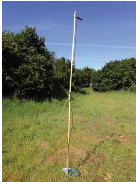
Détecteur automatique d'ultrasons avec microphone installé à 2 m du sol, à l'emplacement prévu d'une éolienne. © J. Sudraud
