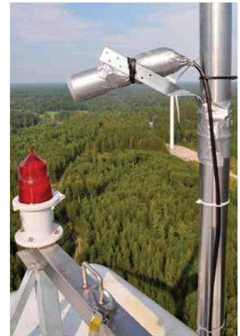
Microphone installé au-dessus de la nacelle pour une étude avec détecteur automatique d'ultrasons. © J. Rydell
