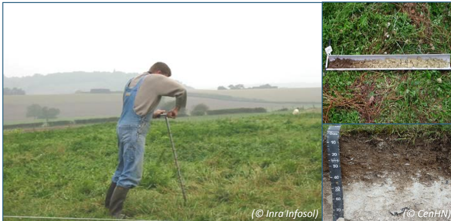
Figure 2 : phase de terrain, sondage à la tarière et fosse pédologique
